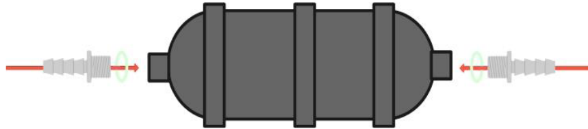
Imagen 7 - Atornillar conexiones (racores) de la manguera
