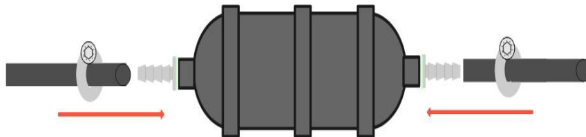
Imagen 8 - Conexión de los extremos de las mangueras con filtro SGI
