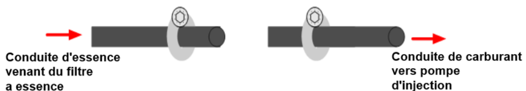
Figure 5 - Les colliers de serrage sont placés sur le tuyau de carburant
