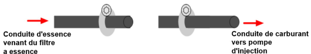
Figure: Les colliers de serrage sont placés sur le tuyau de carburant
